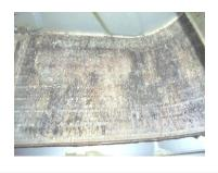
熱交換器はアルミのフィンで製造されており、空気中の埃や油分で<u>目詰まりし</u>やすい部品です。
